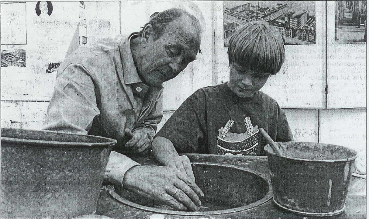
Noch blind sind die Linsen, die auf der Tretmaschine geschliffen werden. Gerhard Koutny zeigt der neunjährigen Claudia Hertel, wie die alte Schleifmaschine, die in der optischen Produktion verwendet wurde, funktioniert. Koutny war selbst 40 Jahre lang im Zeiss-Betrieb beschäftigt.
